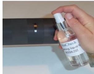
Curatati lichidul FerroFluid de pe suprafata rolei cu solutia AniCheck de curatat.
