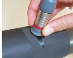
Efectuati trei masuratori pe suprafata Anilox, in interiorul cercului folosind lichidul FerroFluid.
