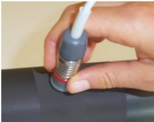
Efectuati trei masuratori Anilox in interiorul cercului fara lichidul FerroFluid.
